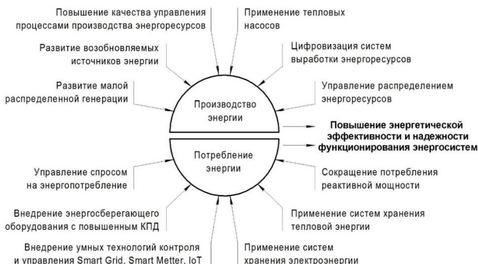
Рис. 9. Направления повышения энергетической эффективности и надежности функционирования мировой энергосистемы в условиях современного технологического развития
