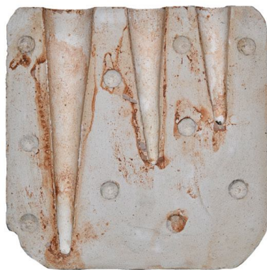
Рис. 4. Гипсовая форма и результат изготовления в ней конусов
