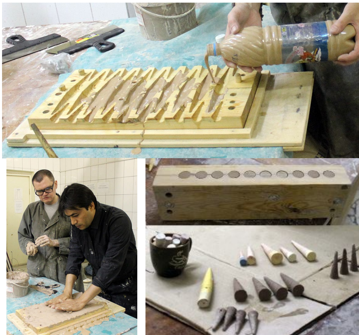
Рис. 5. Процесс и результат изготовления конусов в формах из древесины
