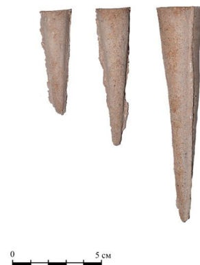
Рис. 4. Гипсовая форма и результат изготовления в ней конусов
