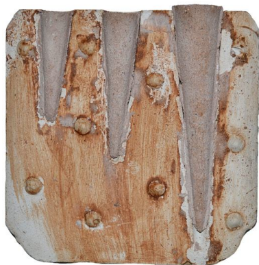
Рис. 4. Гипсовая форма и результат изготовления в ней конусов
