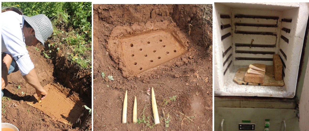
Рис. 6. Изготовление конусов методом «граунт»
